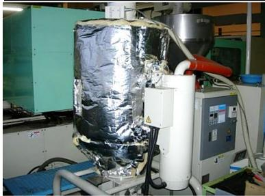
成形樹脂の乾燥(80℃設定)をするためのドライヤーホッパー外周に断熱材を設置した。乾燥機表面からの放熱及び外気温からの影響を抑制し、電力使用量を削減する。特に温度差が大きい冬期間における樹脂乾燥温度の安定化も図られている。
