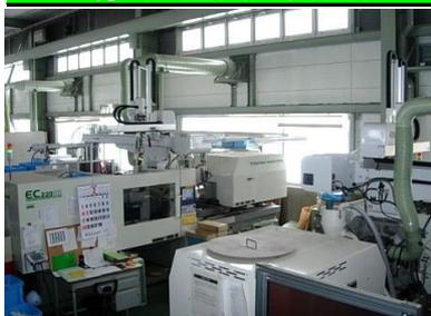
工場内の壁の色が以前はグレー色(灰色)であったため、壁を白色に塗装した。トンネル内の視認性UPの手法を取り入れ、日中は日光、夜間は照明の反射による明るさUPの効果をもたらしている。また成形機を明るい色にする事によってさらなる効果UPとなっている。
