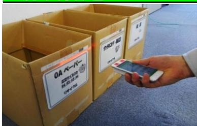
各部署からの廃棄物重量がパソコンへの手入力であったため、各廃棄物別にバーコード化し、端末(バーコードリーダー付き)利用によりデータ送信し、リアルタイムに重量把握することが可能になった。端末は通常作業の中で部品入出庫の際に使用しているため容易に操作できるメリットがある。
