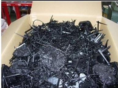
成形工程における、樹脂換えのパージ及び部品ランナー等を各樹脂毎、色毎に分別・回収する。細分化して分別したリサイクル材は業者によりペレット化(破砕品含む)し、再利用している。
