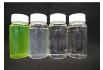
左より①OZ 原水槽／②オゾリス処理後／③MF 透過水／④活性炭通水後
