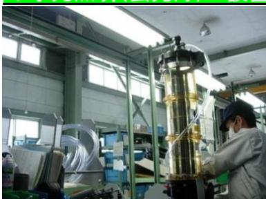
各職場の必要なエリアに蛍光灯(32W)を設置し、既設水銀灯(750W等)の使用を控えた。明るさは照度の確認済みで夏場は問題ないが、冬場においては必要に応じて水銀灯との併用で安全作業を心掛ける。
