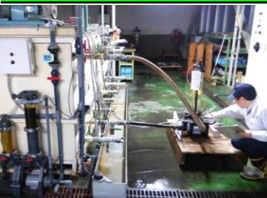
自社製品の出荷テストに使用した水は、そのまま排出せず、貯水槽に戻してリサイクルする。(自動制御) なお、貯水槽内の水はろ過機で循環させ、水の清浄度を保持している。(ろ過機及びポンプは当社製品使用)
