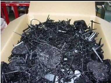
成形工程における、樹脂換えのパ-ジ、及び部品ランナ-等を各樹脂毎、色毎に分別・回収する。細分化して分別したリサイクル材は業者によりペレット化(破碎品含む)し、再利用している。
