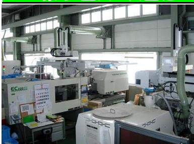
工場内の壁の色が以前はグレ-色(灰色)であったため、壁を白色に塗装した。トンネル内の視認性UPの手法を取り入れ、日中は日光、夜間は照明の反射による明るさUPの効果をもたらしている。また成形機を明るい色にする事によってさらなる効果UPとなっている。
