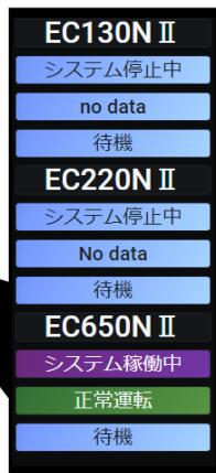
部品の入出庫で用いている端末の画面で、成形機の運転状態を可視化する「異常監視システム」を構築。
