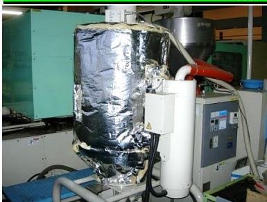
成形樹脂の乾燥(80°C設定)をするためのドライヤ-ホッパー-外周に断熱材を設置した。乾燥機表面からの放熱及び外気温からの影響を抑制し、電力使用量を削減する。特に温度差が大きい冬期間における樹脂乾燥温度の安定化も図られている。
