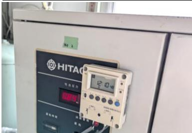
成形機の周辺設備(コンプレッサー、樹脂乾燥機など)にタイマーを設置することで、成形機の夜間生産が終了したときに無人であっても設備の電源をOFFにすることができる。
